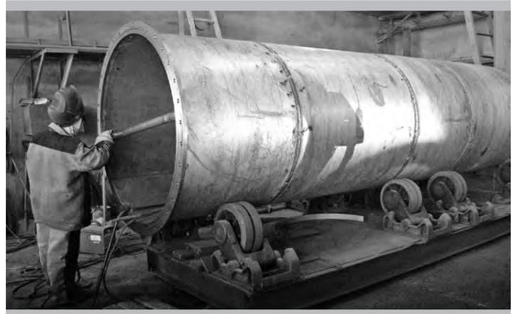
Корпус дохлоратора для цеха № 7 (за работой – Н.Н. Зворыгина)
