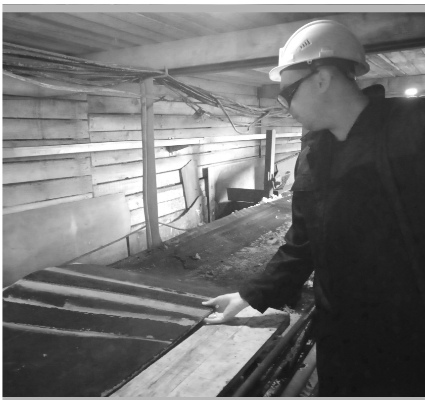
«Здесь ведётся склейка стыков», – демонстрирует бригадир М.А. Анютин
