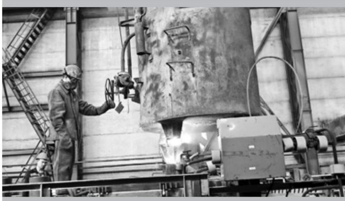
Идёт заливка печи расплавом магния
