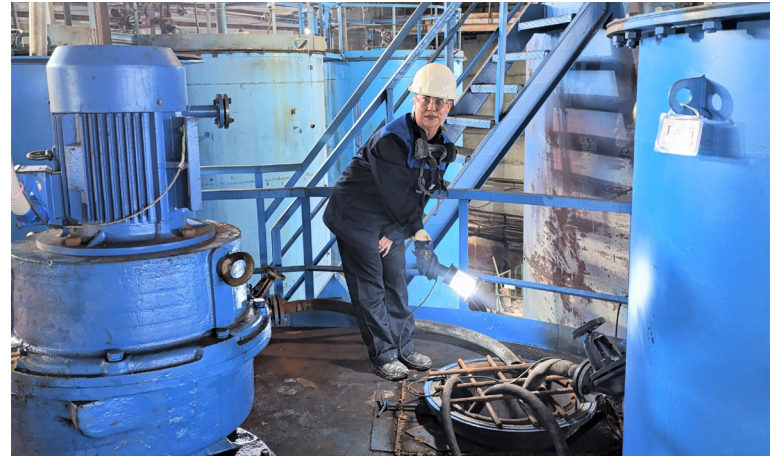
Дарья Федотова проверяет уровень раствора в баке разложения гипохлоритных пульп
